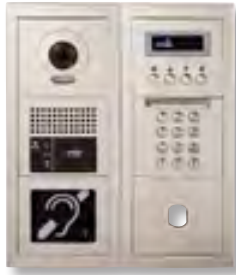
GTBVH (200274) Platine vidéo accessibilité avec boucle magnétique Dimensions : 320 x 270 x 16 mm Encastrement : 295 x 245 x 44 mm Boîtiers d'encastrement GF3B x 2 non inclus
